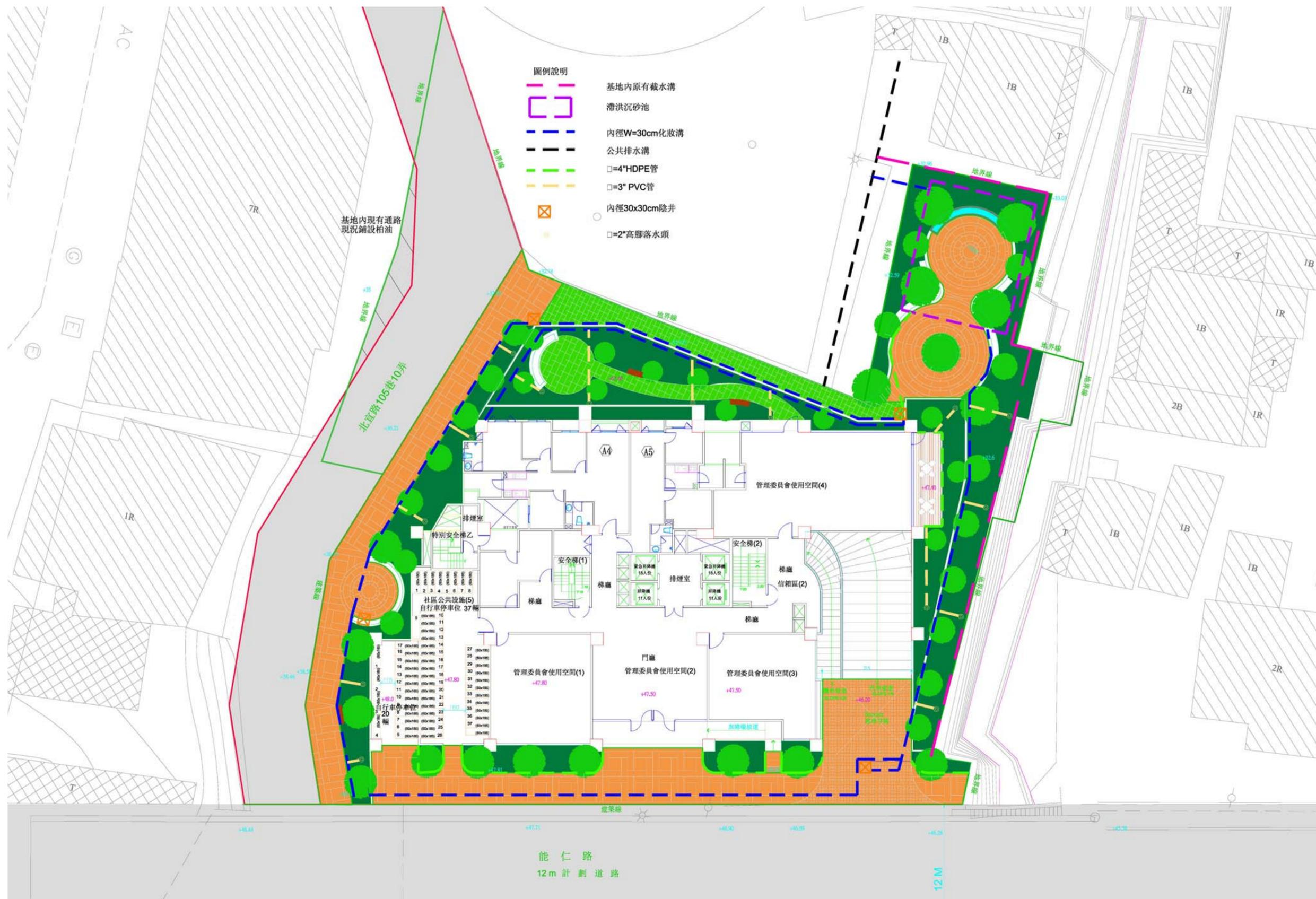
圖 12-24 一層排水設施示意圖(S : 1/300)
